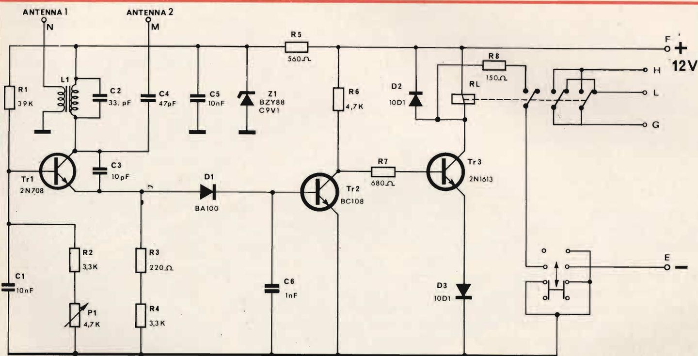
Fig. 1 - Schema elettrico.
