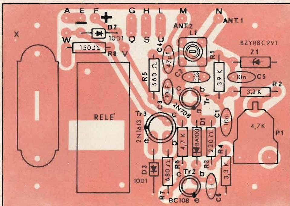
Fig. 2 - Disposizione dei componenti sul circuito stampato.
