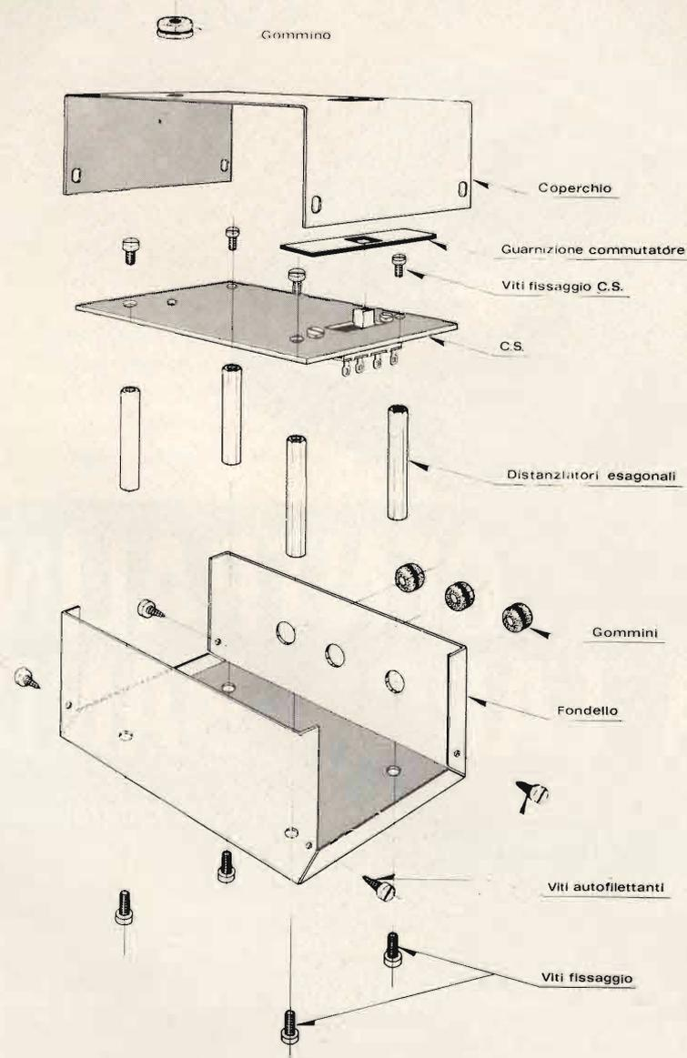
Fig. 5 - Esploso di montaggio contenitore - piastra C.S.
