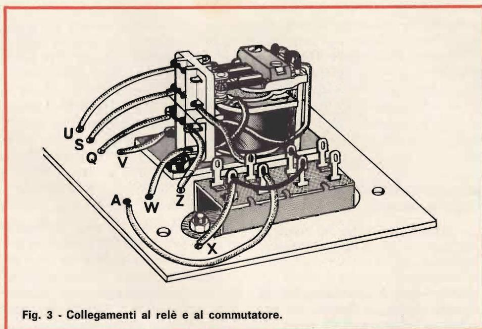
Fig. 3 - Collegamenti al relè e al commutatore.
